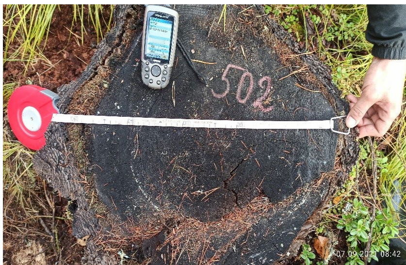
Рисунок 1. Ступенчатая трещина на поперечном срезе лиственницы
