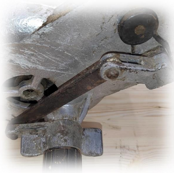
Выключатель электропилы ВАКОПП
