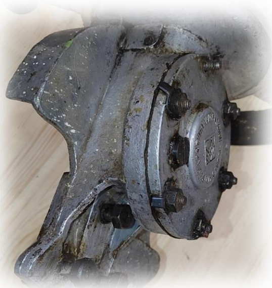
Редуктор электропилы ВАКОПП
