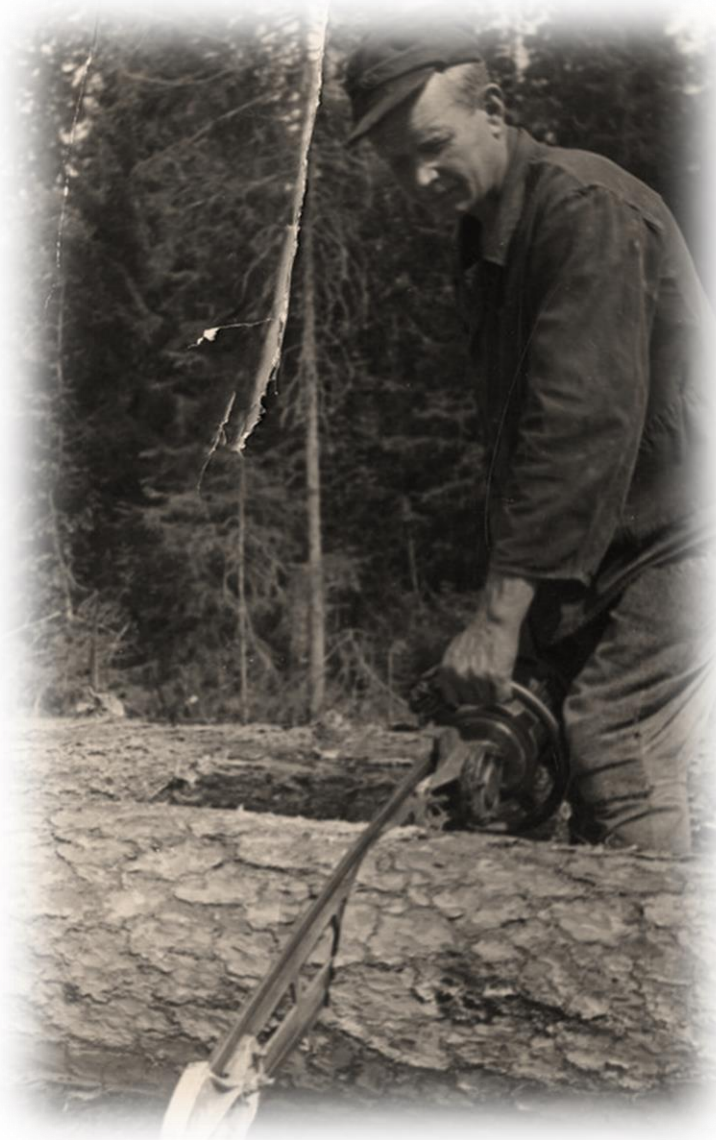
Раскряжевка сосны электропилой. Электропильщик Шуйско-Виданского леспромхоза Южкареллеса Вяйно Сауко (Автор фото: Берлинер Я.Л.)
