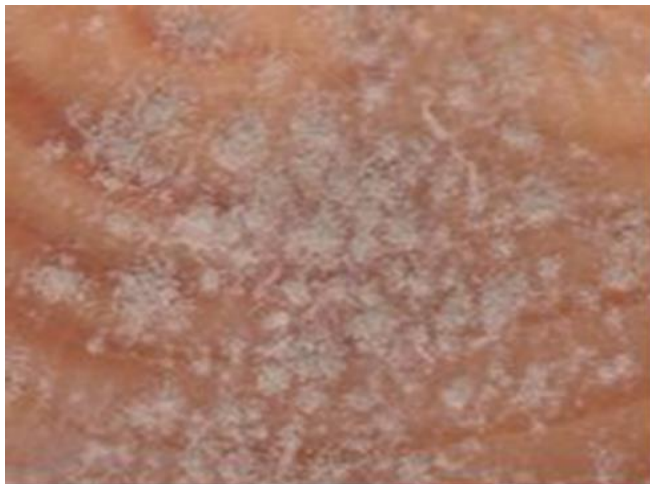
Рисунок 2. Внешний вид образца древесины, обработанного препаратом при разбавлении 1:99 после 15-дневного экспонирования
