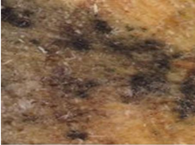
Рисунок 1. Внешний вид незащищённого препаратом образца древесины после 15-дневного экспонирования
