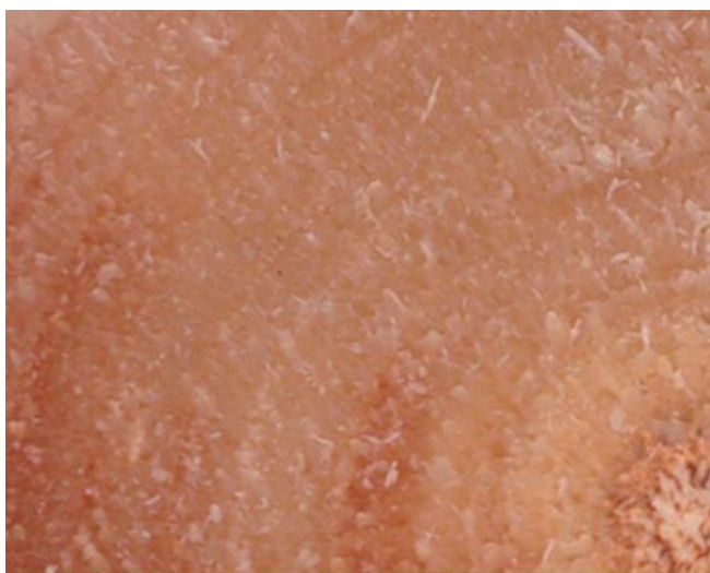
Рисунок 3. Внешний вид образца древесины, обработанной препаратом при разбавлении 1:49 после 15-дневного экспонирования
