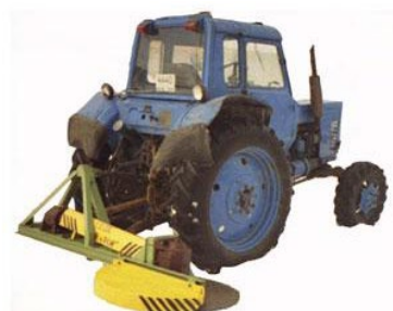
Рис. 25. Кусторез тракторный с дисковым органом КРТ-1Б на базе МТЗ-82
