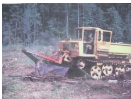
Рис. 26-27. Корчевательное (съёмное) оборудование КП-06 (МП-18-6) устанавливается на тракторах Т-10М, Т-170, Б-10, имеет сменные рабочие органы. Предназначено для расчистки площадей (коридоров, полос и сплошных вырубок) от малоценного молодняка с вычесыванием корней, корчевки пней (диаметром до 65 см), уборки валежника и порубочных остатков
