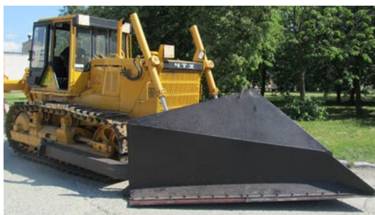
Рис. 24. Кусторез фронтального типа с клиновидным отвалом, оснащенный ножами-лезвиями для срезания и очистки площадей от малоценного молодняка на базе трактора Т-10М
