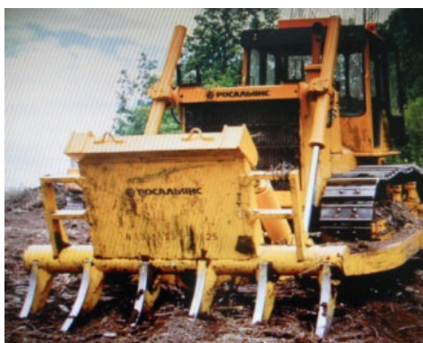
Рис. 26-27. Корчевательное (съёмное) оборудование КП-06 (МП-18-6) устанавливается на тракторах Т-10М, Т-170, Б-10, имеет сменные рабочие органы. Предназначено для расчистки площадей (коридоров, полос и сплошных вырубок) от малоценного молодняка с вычесыванием корней, корчевки пней (диаметром до 65 см), уборки валежника и порубочных остатков
