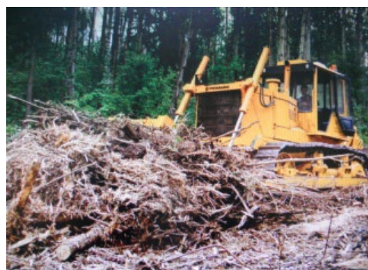
Рис. 26-27. Корчевательное (съёмное) оборудование КП-06 (МП-18-6) устанавливается на тракторах Т-10М, Т-170, Б-10, имеет сменные рабочие органы. Предназначено для расчистки площадей (коридоров, полос и сплошных вырубок) от малоценного молодняка с вычесыванием корней, корчевки пней (диаметром до 65 см), уборки валежника и порубочных остатков
