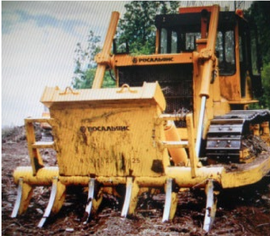
Рис. П13.3. Корчевательное (съёмное) оборудование КП 06 (МП-18-6), устанавливаемое на тракторах Т-10М, Б-10, Т-170. Предназначено для расчистки лесных площадей (коридоров, полос и сплошных вырубок) от малоценного молодняка с вычесыванием корней, корчевки пней, уборки валежника и порубочных остатков.
