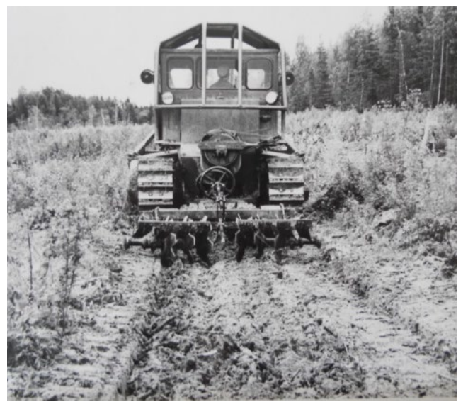
Рис. П1.8. Дискованием почвы с тяжелой бороной БДТ-2,2 после прохода корчевателя Д-210В
