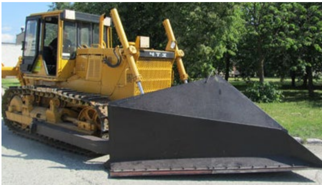
Рис. П13.1. Кусторез с клиновидным отвалом, оснащенный ножами-лезвиями для срезания и расчистки площадей с малоценным молодняком диаметром до 12 см, на базе трактора Т-10М (производится на Челябинском тракторном заводе)
