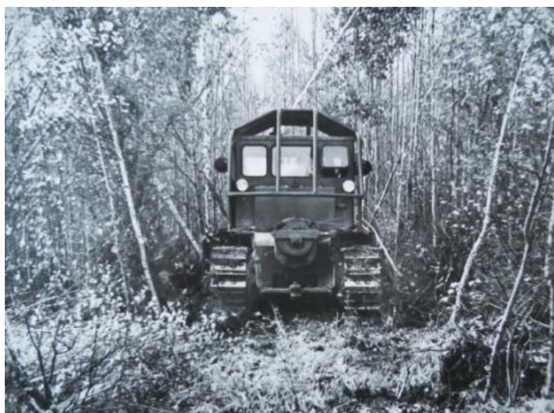
Рис. 2.8. Расчистка коридора шириной 4 м кусторезом Д-174Б на базе трактора С-80 (1957 г.)
