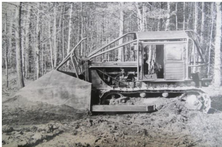
Рис. 2.13. Кусторез фронтального типа Д-174Б на базе трактора С-80
