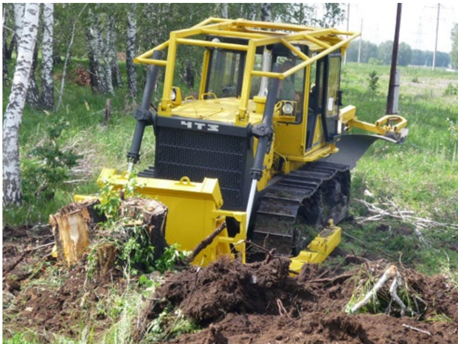
Рис. П13.4. Специализированный агрегат КП-06 на корчевке пней
