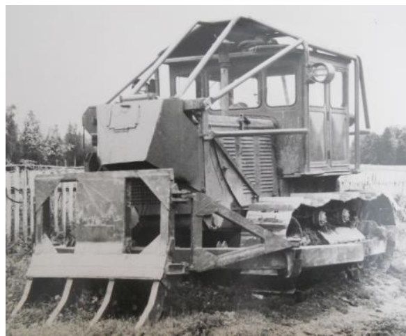
Рис. 2.14. Корчеватель-собираатель Д-210В на базе трактора С-80
