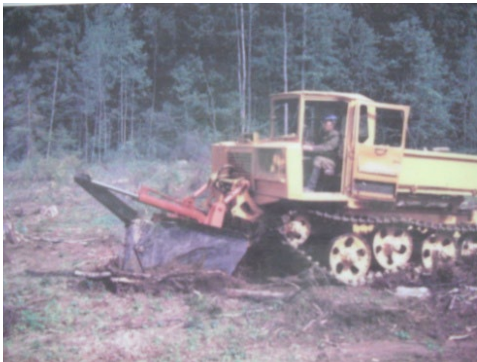
Рис. П13.5. Орудие ОРВ-1,5 для узкополосного (1,5 м) способа расчистки площадей от пней, корневищ молодняка и порубочных остатков. Орудие агрегируется с тракторами ЛХТ-55 (100), ЛХТ-4.
