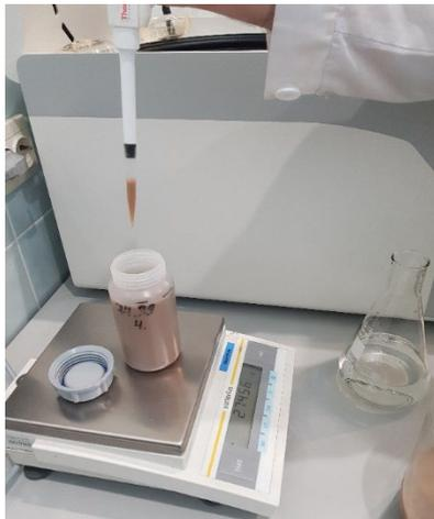
Рис. 12. Процесс уравнивания центрифужных стаканов и установка их в центрифугу
