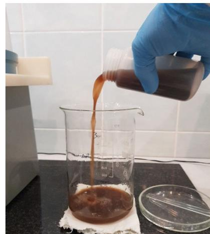
Рис. 13. Разделенный на фракции фильтрат и слив фугата после центрифугирования
