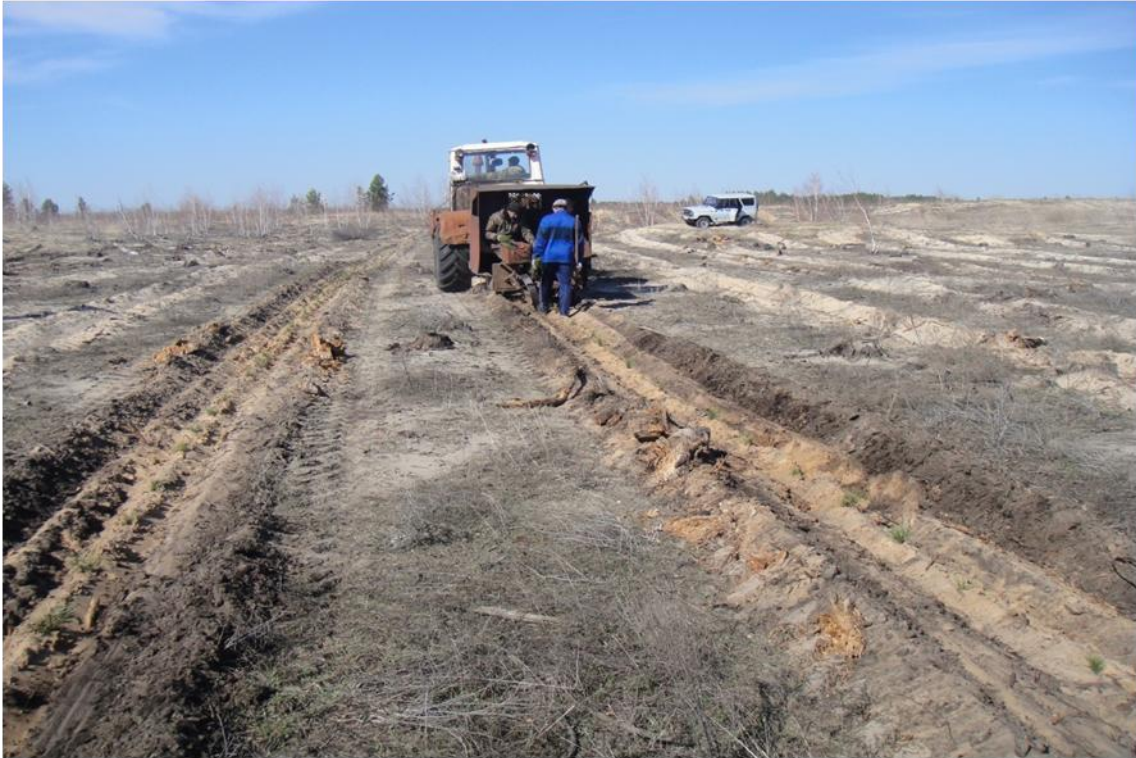
Рисунок 7. Посадка семян сосны машиной МТУ-1 по бороздам плуга ПКЛ-70
