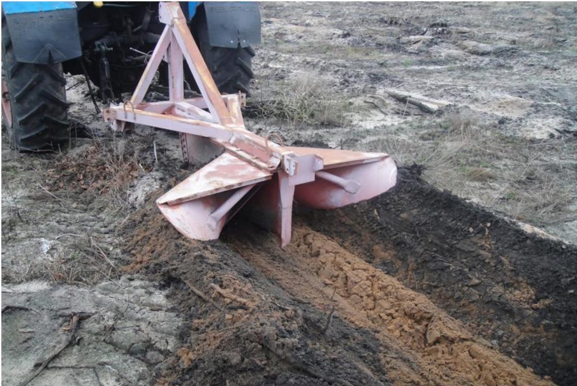
Рисунок 5. Плуг ПРЛ-70 в работе на расчищенном горельнике
