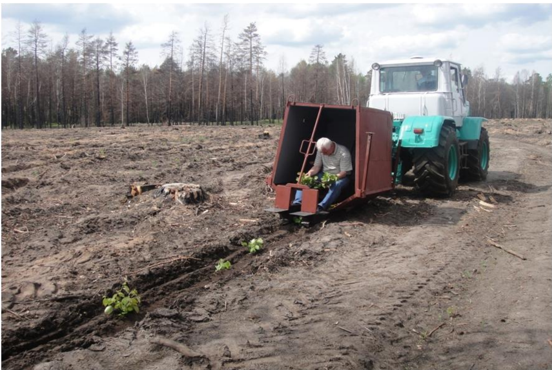
Рисунок 6. Посадка машиной МПС-1 без обработки почвы (сеянцы липы)
